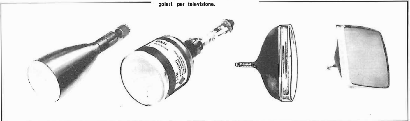
Fig. 57 G - Il primo a sinistra, è un tubo molto impiegato in questi ultimi anni negli oscillografi: è il 5-UP-1, con schermo, dal diametro di cm 13 circa (5 pollici) e traccia verde. Accanto ad esso, un tubo (a deflessione elettromagnetica) per impieghi professionali (ad esempio, analisi di diapositive, controllo di telecamere, ecc.); la traccia è bianca e la definizione dell'immagine molto elevata. Infine, due tubi (grande e piccolo schermo) rettangolari, per televisione.
