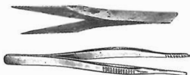
Fig. 3 B - La caratteristica «pinza a molla», molto utile per l'esecuzione dei collegamenti e per il collocamento dei piccoli componenti.
