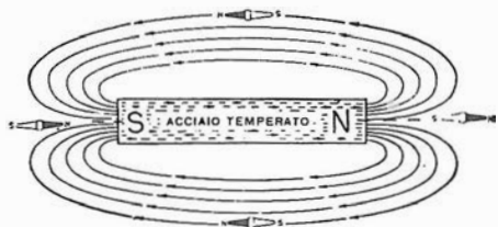
Fig. 34 D - Mediante una bussola è possibile determinare la polarità di un magnete: il polo Nord dell'ago dello strumento è infatti sempre rivolto verso il polo Sud del magnete.
