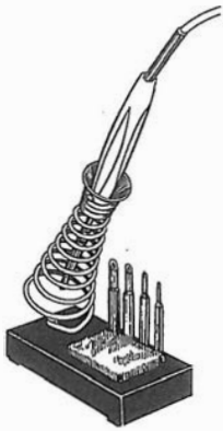
Fig. 24 B - Vi sono diversi modelli di supporti per saldatori; uno tra i più semplici, di costruzione anche assai facile ed economica, è quello ad «M» quale lo si vede a destra, in figura. La spirale-supporto dell'altro tipo illustrato agevola la dissipazione di calore, a riposo.
