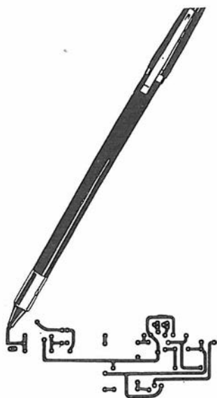
Se sulla piastra di rame si traccia il percorso dei collegamenti con inchiostro-vernice appositamente, durante il successivo bagno di incisione viene eliminato tutto il restante rame tranne, appunto, quello che si trova sotto al tracciato. Per l'esecuzione di prototipi sono in vendita piastre pronte, penne ed inchiostri idonei.
