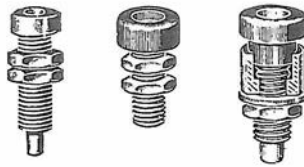
Fig. 33 B - Boccole per «banane», tra le quali una — quella a destra — isolata dal pannello sul quale va fissata.
