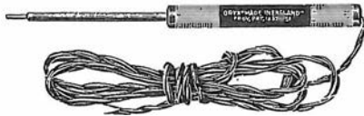
Fig. 29 B - Saldatore a bassa tensione, di estrema leggerezza. È simile ad una matita ed è indispensabile per saldature su organi piccoli e delicati quali i transistori, i diodi a semiconduttore, i circuiti integrati.
