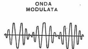
Fig. 43 - Con la sovrapposizione del segnale modulante, l'ampiezza della portante, originariamente di valore costante, viene fatta variare. Il segnale modulante può, al caso, far variare la frequenza invece dell'ampiezza.
