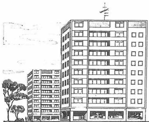
Fig. 17 bis - Antenne come quella illustrata alla figura precedente sono sempre meno impiegate in quanto i trasmettitori sono di notevole potenza ed i ricevitori di alta sensibilità. La tendenza è ora per l'installazione unica per più utenti (antenne centralizzate); si possono raggruppare diversi tipi di antenna (per onde medie, corte, TV, ecc.), rendere più intensi (amplificare) i segnali captati e distribuirli ai ricevitori variamente dislocati tramite un cavo.
