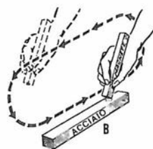
Sistema di magnetizzazione per contatto con un altro magnete.
