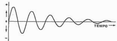
Fig. 8 - L'oscillazione, pur non modificandosi in frequenza, diminuisce di ampiezza col trascorrere del tempo (se non si ripete l'azione che l'ha provocata); così come è qui rappresentata essa è una oscillazione smorzata.
