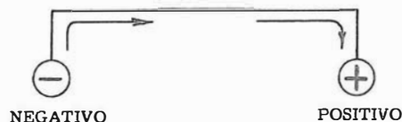
Fig. 18 C - Il movimento di elettroni di cui si è detto (corrente) tra due corpi caricati elettricamente e collegati mediante un conduttore ha luogo finché si verifica la forza che lo determina, ossia la «forza elettromotrice» o «tensione»; cessa quando le due cariche risultano bilanciate.
