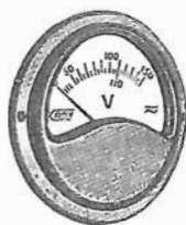
Fig. 35 G - Gli strumenti a ferro mobile hanno il pregio di un costo molto basso: ora sono spesso sostituiti con quelli a bobina mobile, ma ove servono come « spia », con inserzione permanente, possono essere tuttora di impiego.
